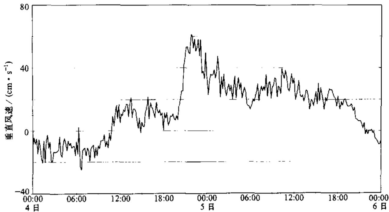
图2 敦煌绿洲内的新型可移动自动气象站的超声风速仪(距离地面约5.6 m)所记录到的地面垂直风速在2000年6月4日沙尘暴过境前后随时间的演变实况
