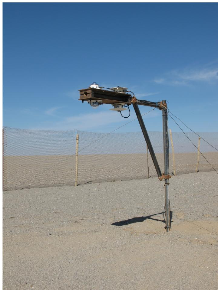
图 2 敦煌荒漠戈壁地区净辐射四分量观测仪
