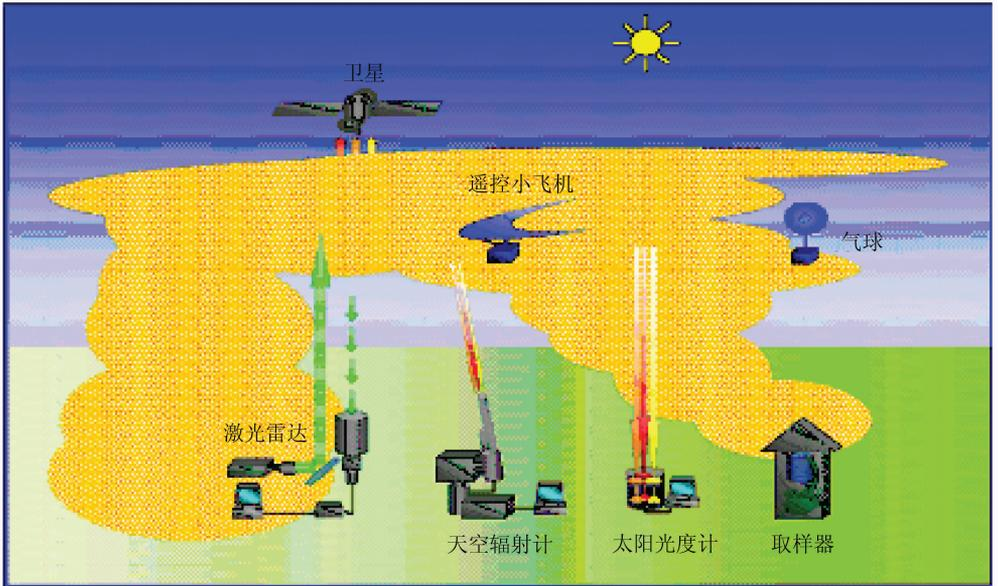
图2 中日 ADEC 项目野外观测仪器示意图<sup>1)</sup>
