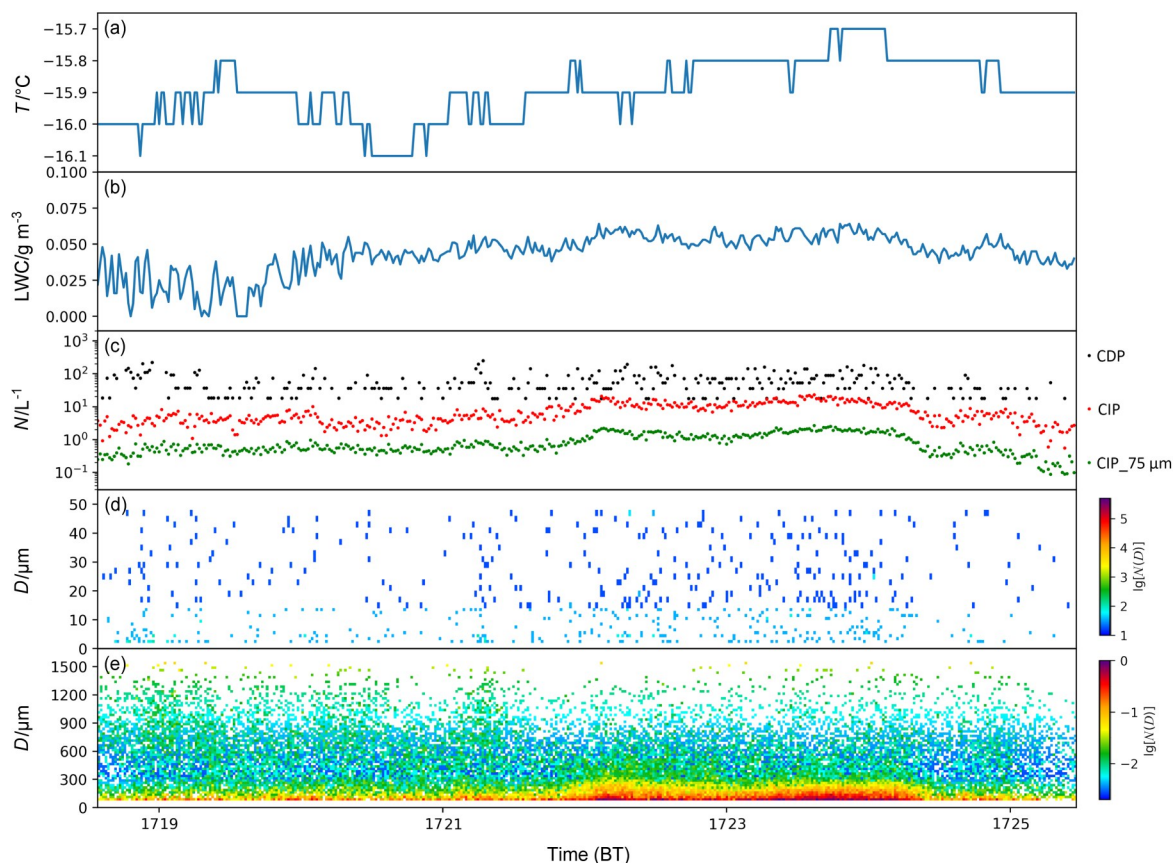
图8 飞机在7260 m高度水平飞行(图1、2中GH段)时观测的数据:(a) 温度;(b) 液态水含量(LWC);(c) 粒子数浓度 N [黑色: 云粒子探头(CDP)观测的粒子浓度, 红色: 云粒子图像探头(CIP)观测的粒子浓度, 绿色: CIP观测的直径75 \mu\text{m} 以上粒子浓度];(d) CDP观测的粒子谱;(e) CIP观测的粒子谱(去除前两个通道, 即直径( D )为75 ~1550 \mu\text{m} 的粒子谱)。观测时间: 2017年5月22日17:18~17:27, 温度范围: -15.7^{\circ}\text{C} \sim -16.1^{\circ}\text{C}
