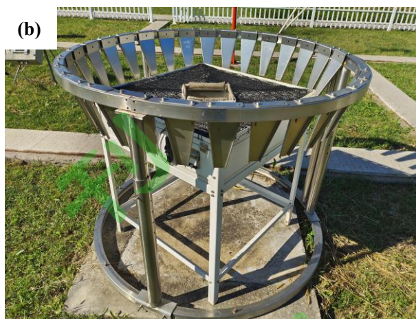
图 1 二维视频粒子谱仪 (2DVD)、称重式降水传感器 (WRG) 和自动站 (AWS) 所在位置 (a) 以及 2DVD 仪器照片 (b)
